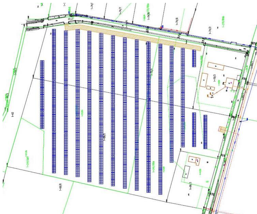
Rysunek 13 Koncepcja rozmieszczenia poszczególnych elementów farmy fotowoltaicznej- wariant alternatywny
